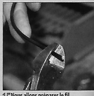
**15** Nous allons préparer le fil de connexion (Ø 1,5 mm). Dénuder une extrémité.
