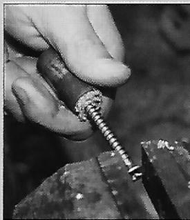
**6** Bloquer la vis entre les mordaches d'un étau et tirer sur le corps du condensateur en faisant des mouvements de torsion. Au début, on n'arrache que des lambeaux.
