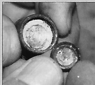
**4** Derrière elle, on voit apparaître la rondelle sur laquelle est soudé le fil de connexion. On pourrait appeler ça l'électrode du "+".
